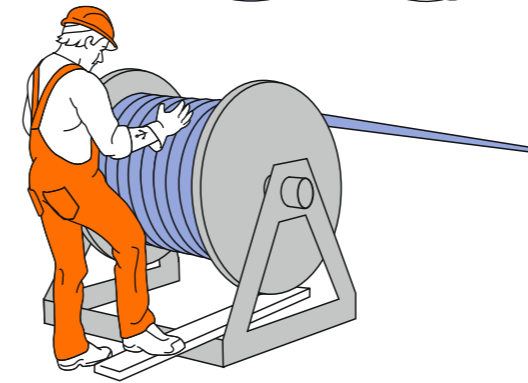
Trosse abbremsen, um das Seil auf Spannung zu halten. A temporary brake ensures the line will remain taut.
